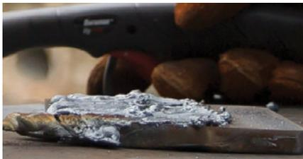
Al utilizar consumibles FlushCut, los operadores pueden esperar dejar menos de 5 mm (3/16 pulg.) de material en la pieza a cortar después de quitar una orejeta, un anexo o una argolla.
