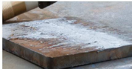
Cuando el anexo se ha quitado, los operadores pueden reducir el amperaje del sistema y limpiar cualquier material restante sin perforar la pieza a cortar. Limpiar con FlushCut también reduce la necesidad de rectificar.
